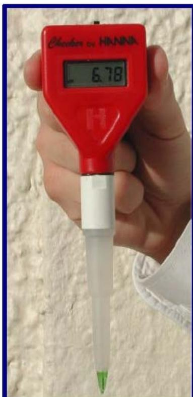
**Figura 1.** Peachímetro con electrodo de pincho.
