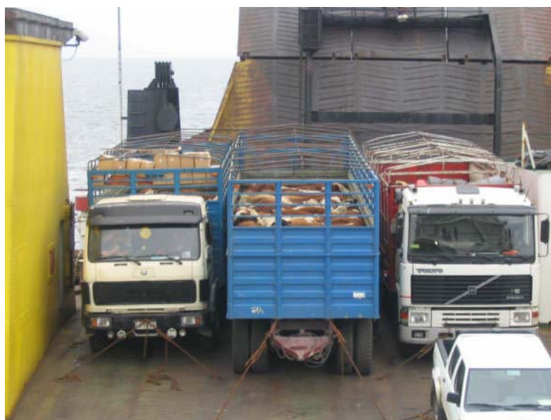
Figura 8: Fijación de los vehículos al barco (sujeción es con cadenas en los cuatro extremos)
