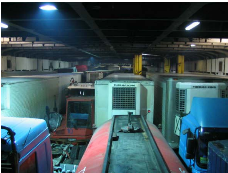
Figura 10: Camiones frigoríficos en la cubierta principal. Nótese el reflejo de la luz en las partículas de humo (extremo superior izquierdo).
