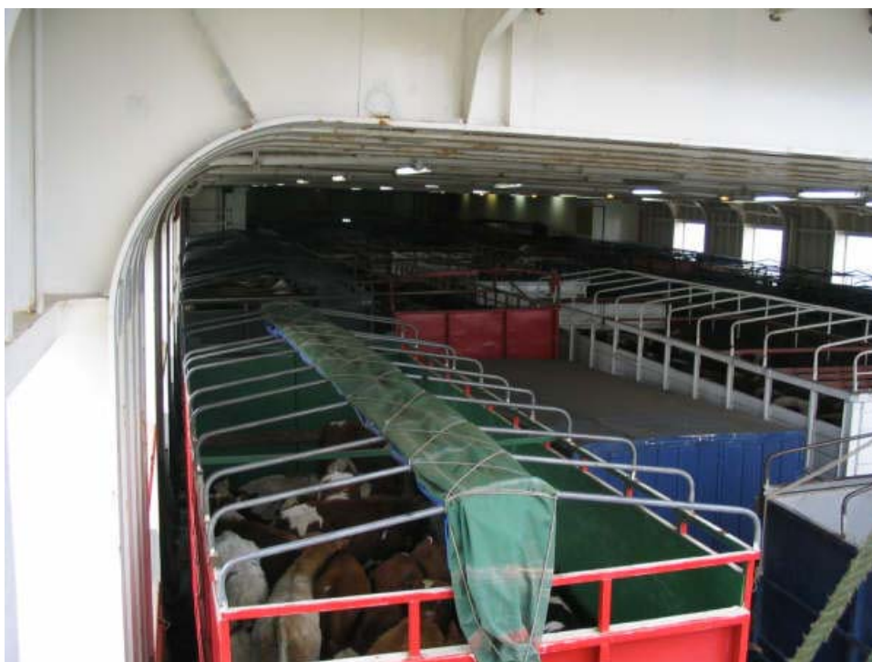
Figura 7: Iluminación de la cubierta superior techada, dada por tubos fluorescentes alineados.
