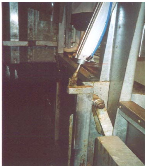
Foto 13: Tijera de inmovilización del cajón de noqueo según estructura inicial.
