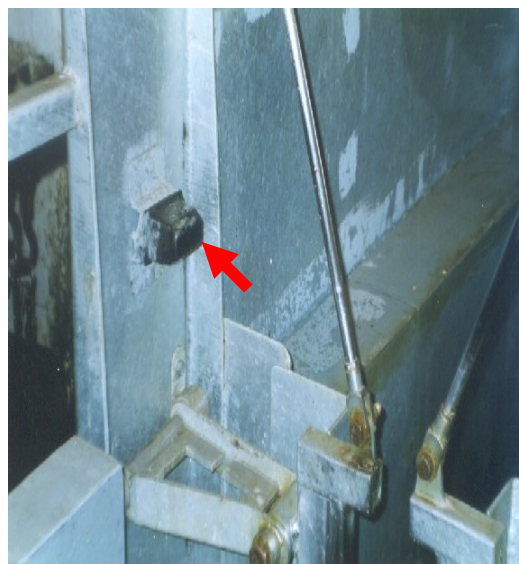
Foto 14: Tijera de inmovilización del cajón de noqueo con tope de goma.
