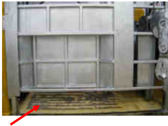
Figura 1. Vista lateral del cajón de noqueo, mostrando el espacio dejado bajo la puerta lateral.
